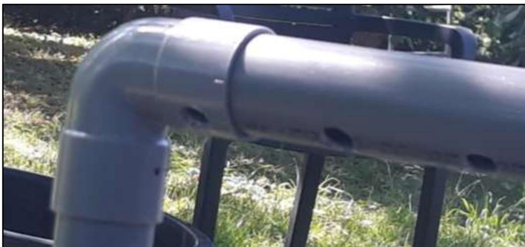
Figure 17 : Fixation du début du 1<sup>er</sup> fil, côté face, en partant de la gauche du tube en haut. Il est fixé par une torsade reliant le 1<sup>er</sup> petit trou et son grand trou correspondant. Un petit trou au bas de l'angle droit de ce côté-ci permet de le passer au travers du petit trou de l'autre côté de la base de l'angle droit.
