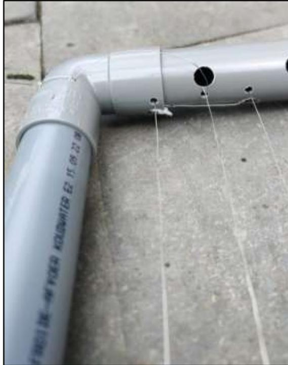
Figure 14 : Raccordement du 2<sup>ème</sup> fil au module HT avec - bien visible - la boucle pour éviter le contact avec 1<sup>er</sup> fil. (Photo J.M. DONCQ)
