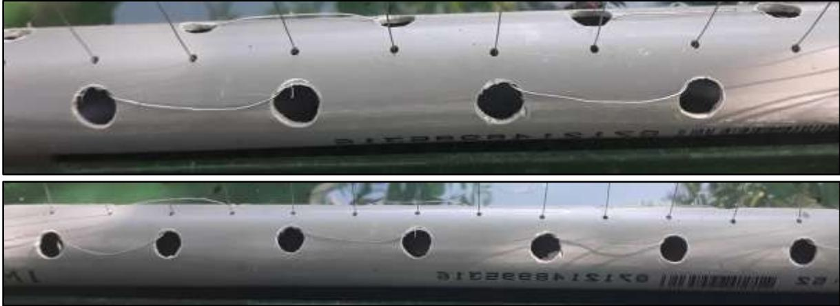
Figure 7 : Vue des trous dans les tubes haut et bas. Au centre, les petits trous par lequel passent les fils aux polarités différentes. De part et d'autre de ces petits trous, les grands trous facilitant le passage des fils dans les petits trous et évitant tout risque de courts circuits entre les deux fils aux polarités différentes. Dans la photo du haut est montré comment ces deux fils sont positionnés l'un par rapport à l'autre. Par fil, à chaque fois un sur deux.
