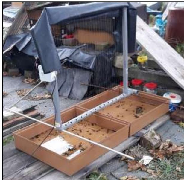
Figure 24 : Photo montrant les deux toits de ruches placés sous la harpe la rendant plus efficace. Vu leurs hauts bords verticaux au-dessus du niveau de l'eau, les FA qui récupèrent assez rapidement du choc reçu ne parviennent pas à s'échapper. La protection provisoire contre la pluie, en bâche PVC pliée, est également bien visible.
