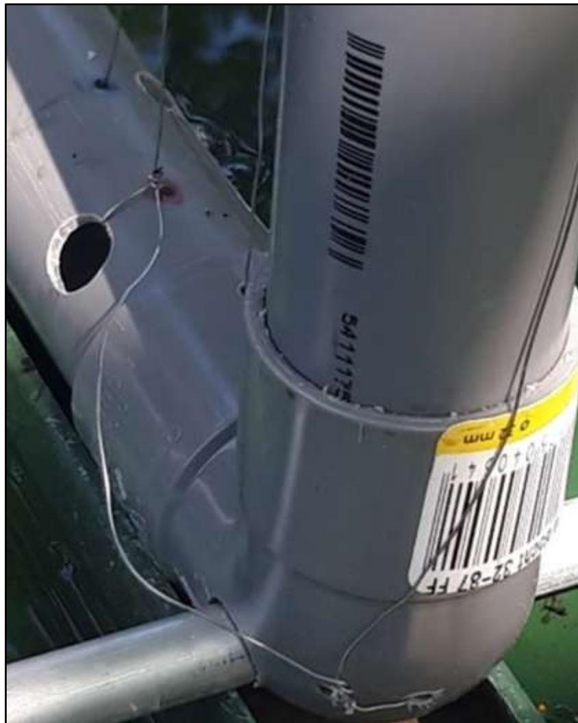
Figure 19 : Fixation du début du 2<sup>ème</sup> fil, partant du 2<sup>ème</sup> trou en bas en partant de la droite sur le tube du bas. Voyez la boucle effectuée pour contourner prudemment le 1<sup>er</sup> fil qui est lui d'une autre polarité. Ici également deux petits trous pour « fixer » au tube le fil qui va relier le 2<sup>ème</sup> fil au Module HT.
