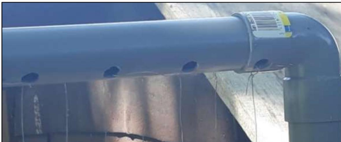
Figure 16 : Exemples de torsades de fin des deux fils. Voyez que les deux fils sont côte à côte en haut du tube supérieur. Cela dépend du nombre pair ou impair des trous s'ils se retrouvent côte à côte ou en haut et en bas.
