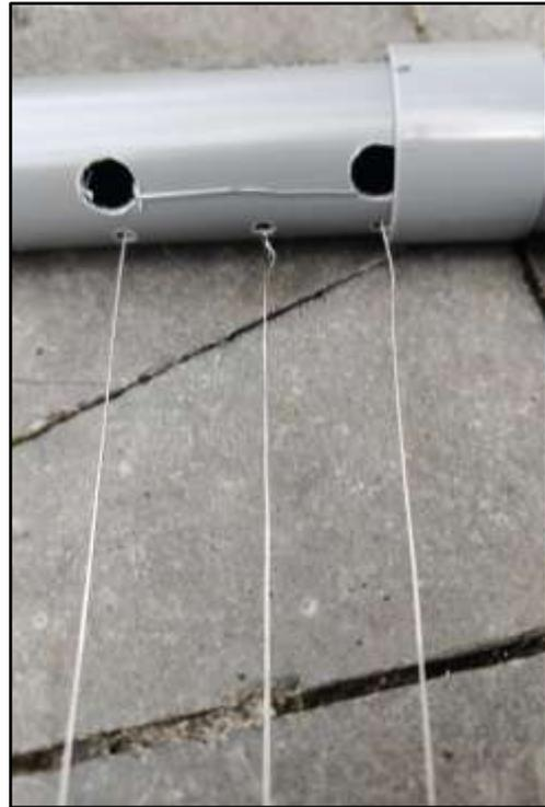
Figure 11 : Point d'arrivée haut du 2<sup>ème</sup> fil en bout de harpe avec torsade analogue. (Photo J.M. DONCQ)
