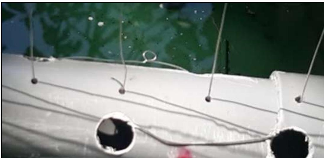
Figure 15 : Exemple de torsade afin de tendre un fil.
