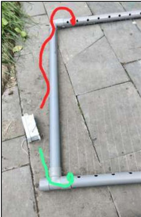
Figure 12 : Points de départ des deux fils - en couleurs différentes pour les différencier – et leurs liens avec les fils du module HT. (Ndlr, pour info, dans ce montage le 1<sup>er</sup> fil part du bas et le second du haut, c'est au choix !) (Photo J.M. DONCQ)
