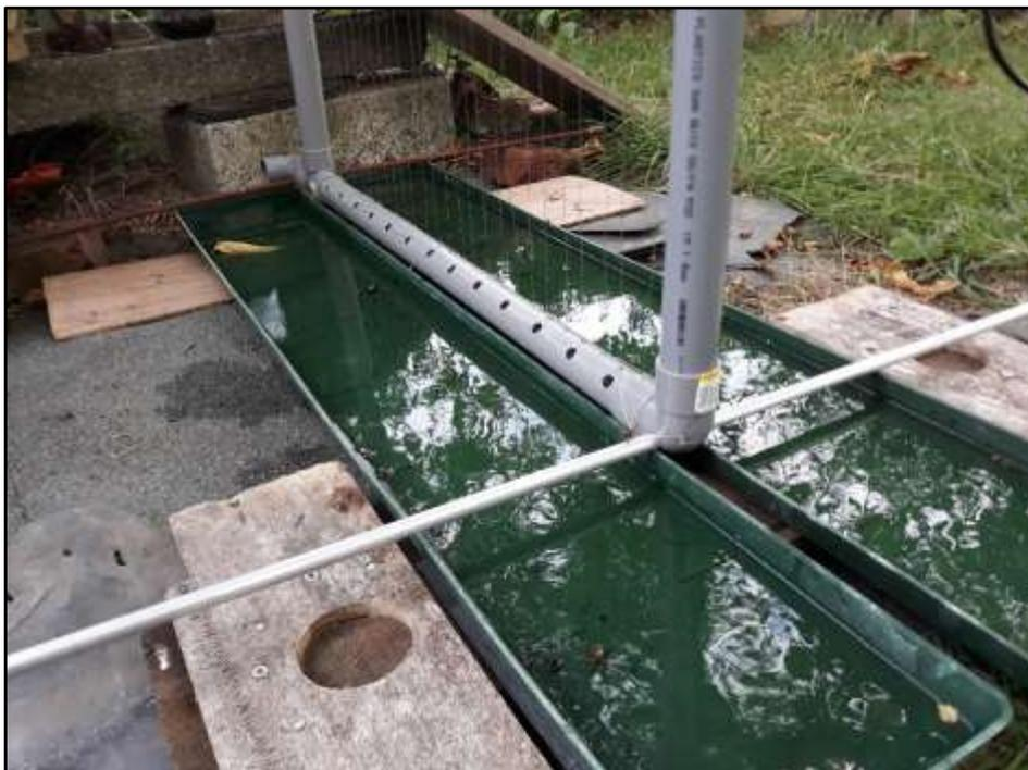
Figure 2 : Vue plus rapprochée de cette harpe montrant comment elle repose sur les deux sous pots de balconnières remplis d'eau avec détergent. Voici comment la harpe est posée grâce à deux tiges passées dans des trous ad hoc percés en bas de l'angle droit devant et du « T » à l'arrière.
