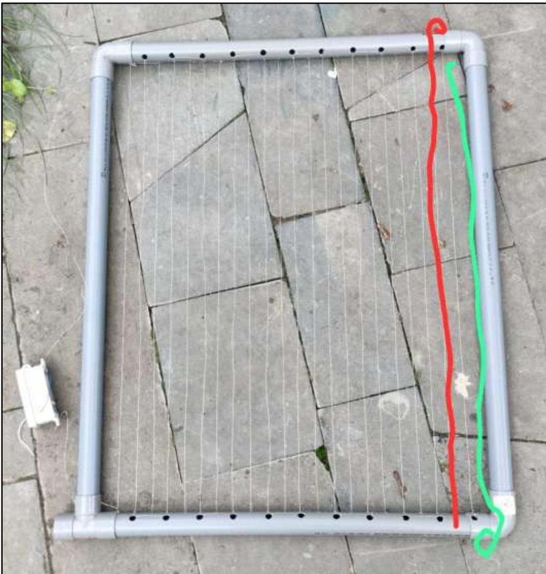
Figure 9 : Points d'arrivée des deux fils, illustrés ici de couleurs différentes pour les différencier. L'un en haut, l'autre en bas selon le nombre pair ou impair des fils. (Photo J.M. DONCQ)
