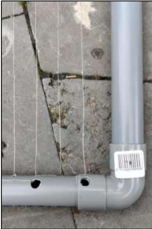
Figure 10 : Point d'arrivée bas en bout de harpe d'un fil avec torsade entre le petit trou et son grand trou correspond. (Photo J.M. DONCQ)
