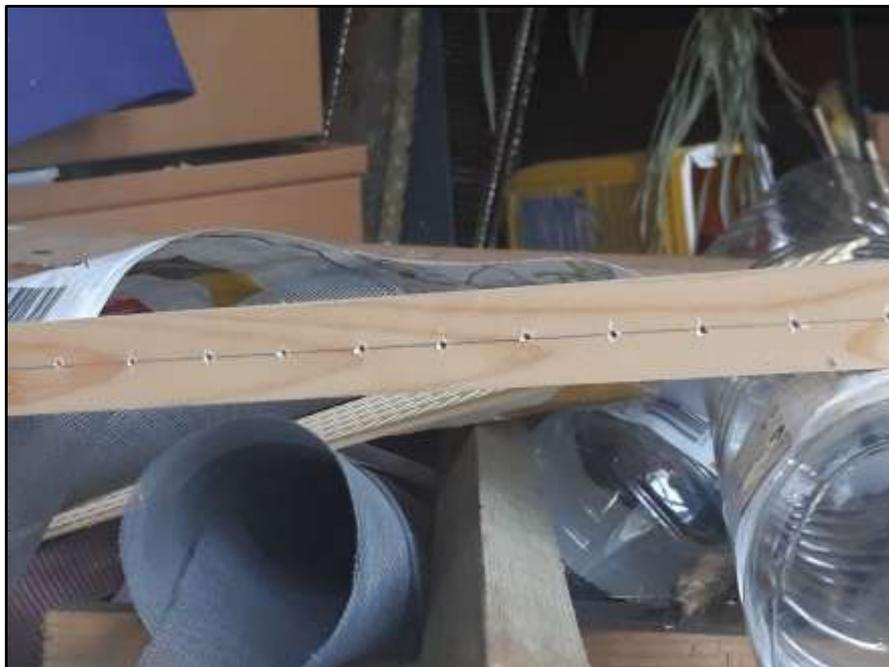
Figure 6 : Modèle de gabarit pour percer les petits trous. Percez les trous aux distances voulues. Ensuite lors de l'usage de ce gabarit posez sa face sur laquelle vous avez foré les trous sur le tube en pvc. Et ensuite assurez-vous au moyen d'adhésif que ce Garabit de bouge pas durant le forage des trous dans le tube en PVC.
